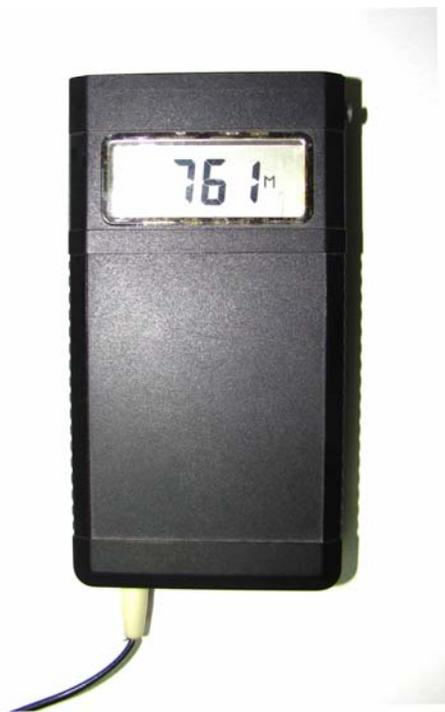
Датчик абсолютного давления с цифровым индикатором хорошо подойдет для измерения атмосферного давления. Диапазон измерения:  $0 \div 1\text{МПа}$ ; диапазон рабочих температур:  $-45 \div + 120^{\circ}\text{C}$ ,
