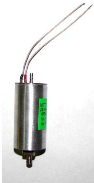
Датчик избыточного давления в диапазоне:  $0 \div 10$ кПа для агрессивных жидкостей и газов;
