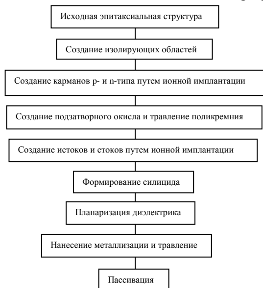
Рис. 1. Технологический маршрут изготовления КМОП-структур
