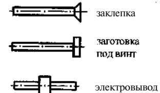
рис. 52. Стержневые детали, получаемые высадкой
