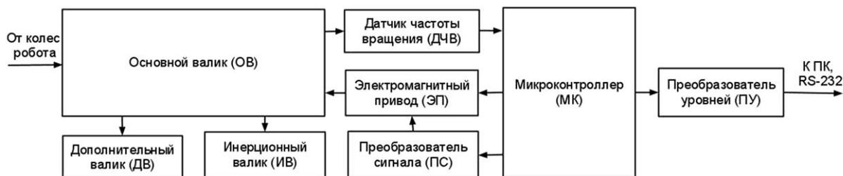
Рис. 2 – Структурная схема обкаточного стенда
