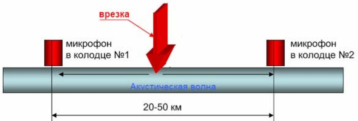
Рисунок 8 - Принцип работы определения врезки датчиками вибрации
